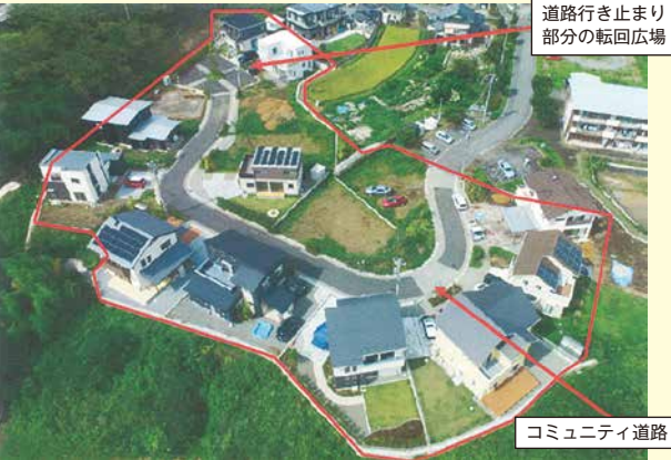
道路行き止まり部分の転回広場
